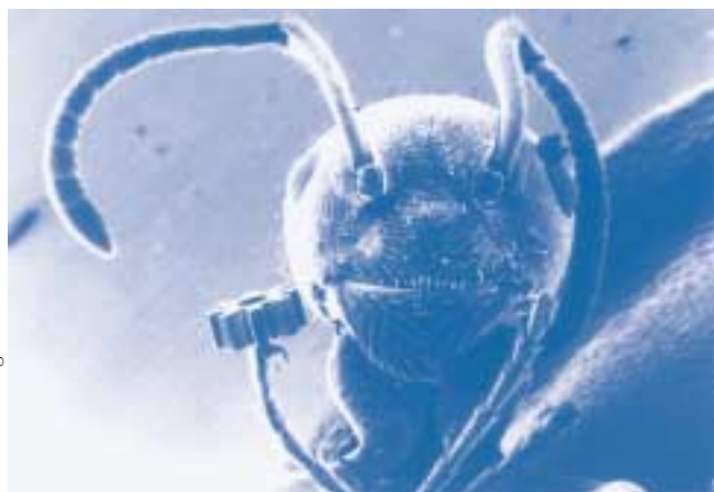
Das Zahnrad auf dem Bein einer Ameise demonstriert die Größe heutiger mikrotechnischer Bauteile.
